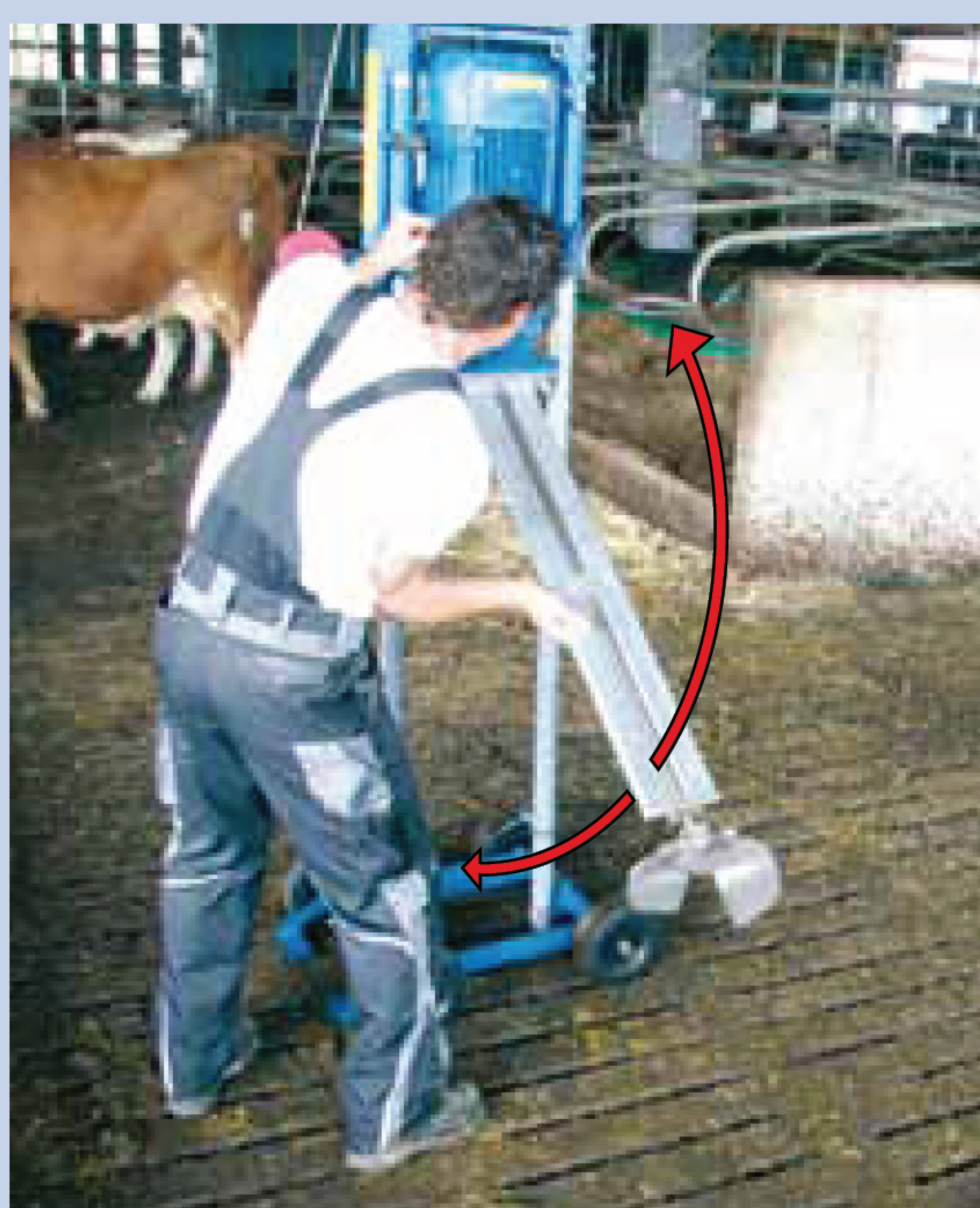
Складываемый вверх миксерный нож на шарнирных соединениях
