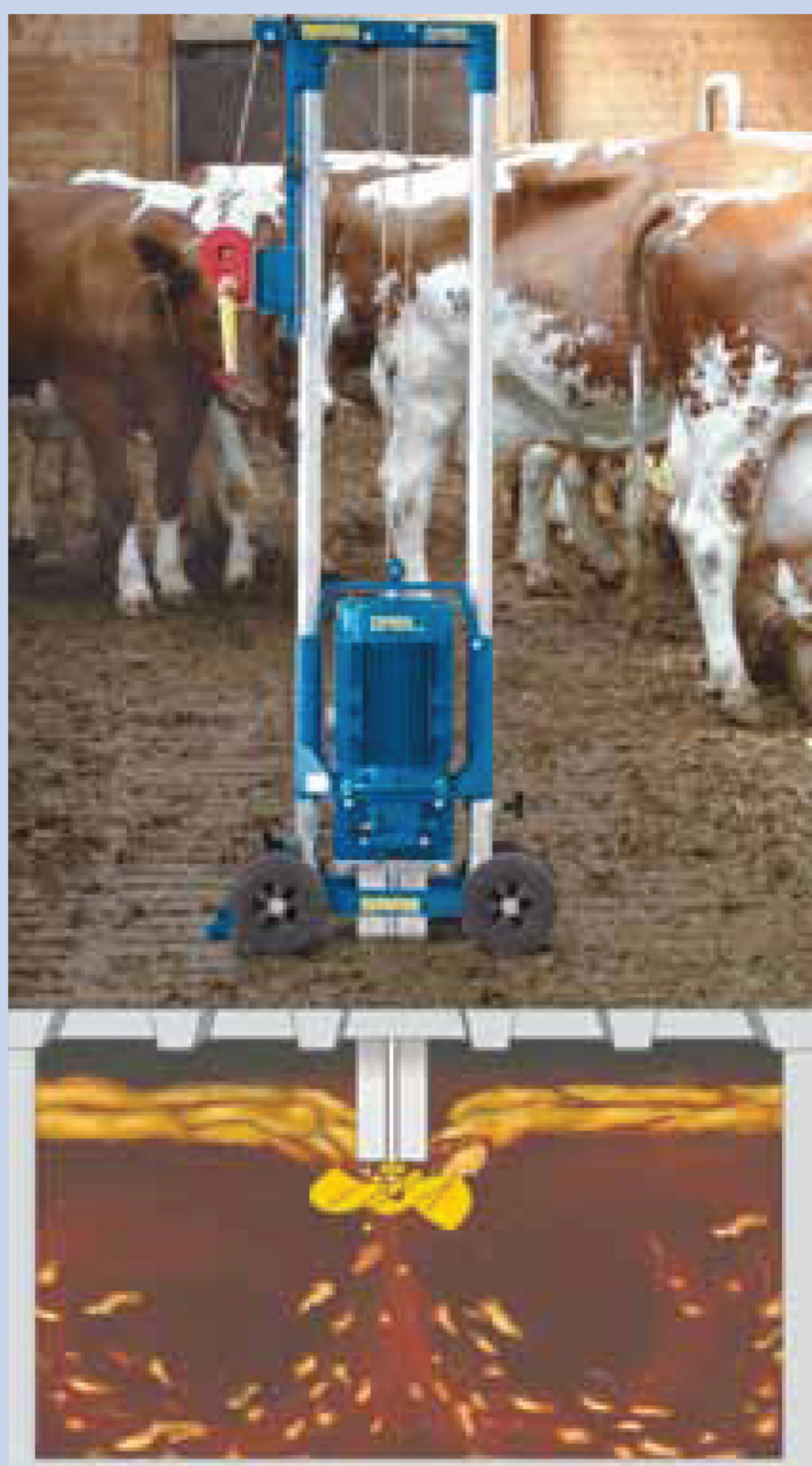
Складной пропеллер создает сильное течение
